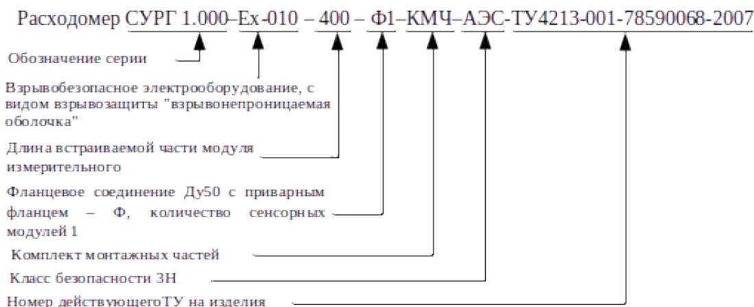
СУРГ 1.000 – Ex-010 – 400 – Ф1 – КМЧ – АЭС – ТУ 4213-001-78590068-2007, что расшифровывается следующим образом: расходомер серии 1.000, с взрывонепроницаемой оболочкой, с длиной встраиваемой части модуля измерительного 400 мм, с приварным фланцем, одним сенсорным модулем, с комплектом монтажных частей, класс безопасности по ОПБ-88/97 ЗН.
